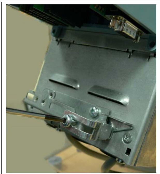
Bild 4-13. Die Schraube der Anschlussklemme entfernen
