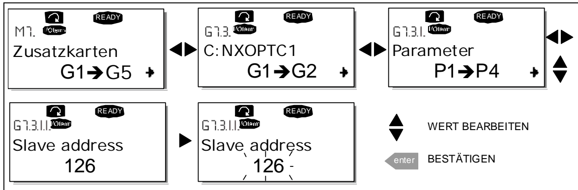
Bild 6-1. Ändern der Parameterwerte für die Profibuskarte
