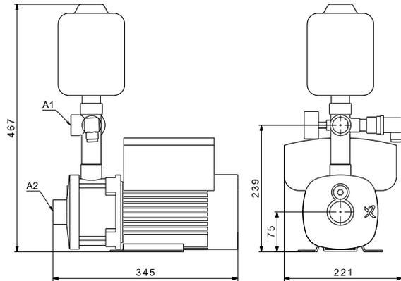
Abb. 6) Abmessungen Basisvariante
