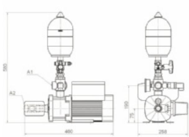
Abb. 7) Abmessungen Trinkwasservariante
