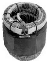
Abb. 18 Ungeregelter Motor mit eingebauter Heizeinheit zur Vermeidung von Kondensation
