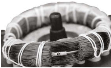
Abb. 20 PTC-Sensor - eingebaut in die Wicklungen
