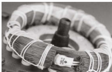
Abb. 22 Thermoschalter - eingebaut in die Wicklungen
